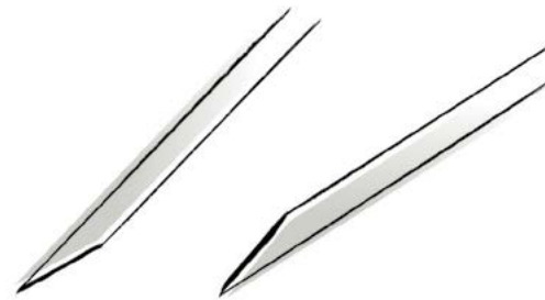
Pointe de l'aiguille biseau vers le bas vs biseau vers le haut
